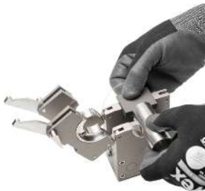
Abb.: Eine an die Spannkassette befestigte und dadurch unverlierbare Rohrmittellehre stellt die exakte Positionierung des zu verschweißenden Rohrstoßes sicher.
