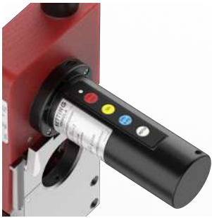
Abb.: Integriertes Bedienfeld – dadurch sind alle für das Schweißen wichtigen Befehle zur Stromquelle übertragbar, so dass keine zusätzliche Fernbedienung benötigt wird.
